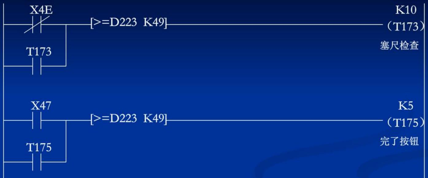
注：塞尺提起1秒以上、按下完了按钮0.5秒以上才能解除报警，以此保证必须进行间隙测定
