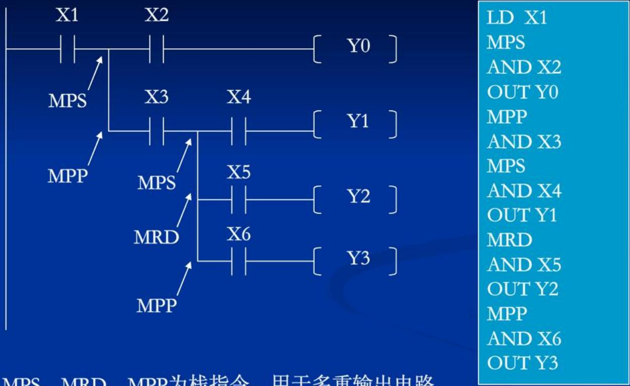
MPS、MRD、MPP为栈指令，用于多重输出电路
