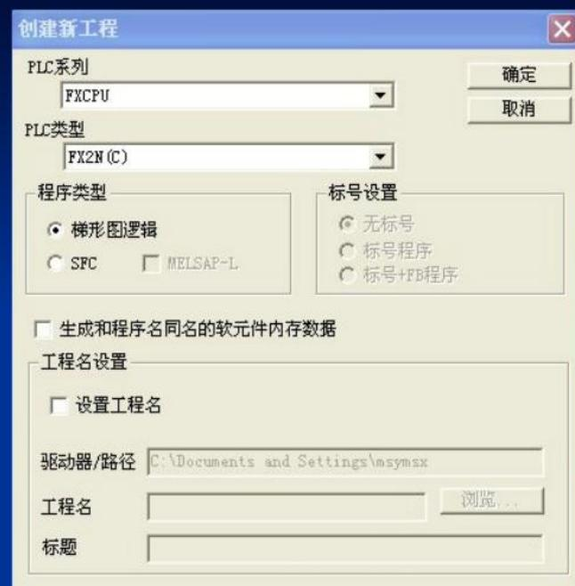
首先点击菜单栏中的“工程”项目，然后点击“打开工程”，出现右图的对话框。用户在“PLC系列”中选择PLC系列，如“A”，“Q”，“FX”系列。在“PLC类型”中选择类型，如“FX1N”，“FX2N”。最后点击“确定”。
