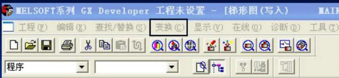
在“变换”下拉菜单中，我们还可以选择“变换编辑中的所有程序”或“编辑时自动变换”
