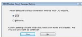
1. 用USB电缆或以太网电缆连接CPU模块与个人计算机。
