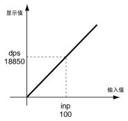
显示流量 (I/min、I/h 等)时,确认输出流量传感器的输入输出特性后进行定标设定。流量传感器也有模拟输出型的,这时应探讨是否使用 K3MA-J 型。
