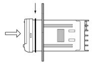
(3)将适配器嵌入后套左右两边的固定槽,推进至面板后使其固定。
