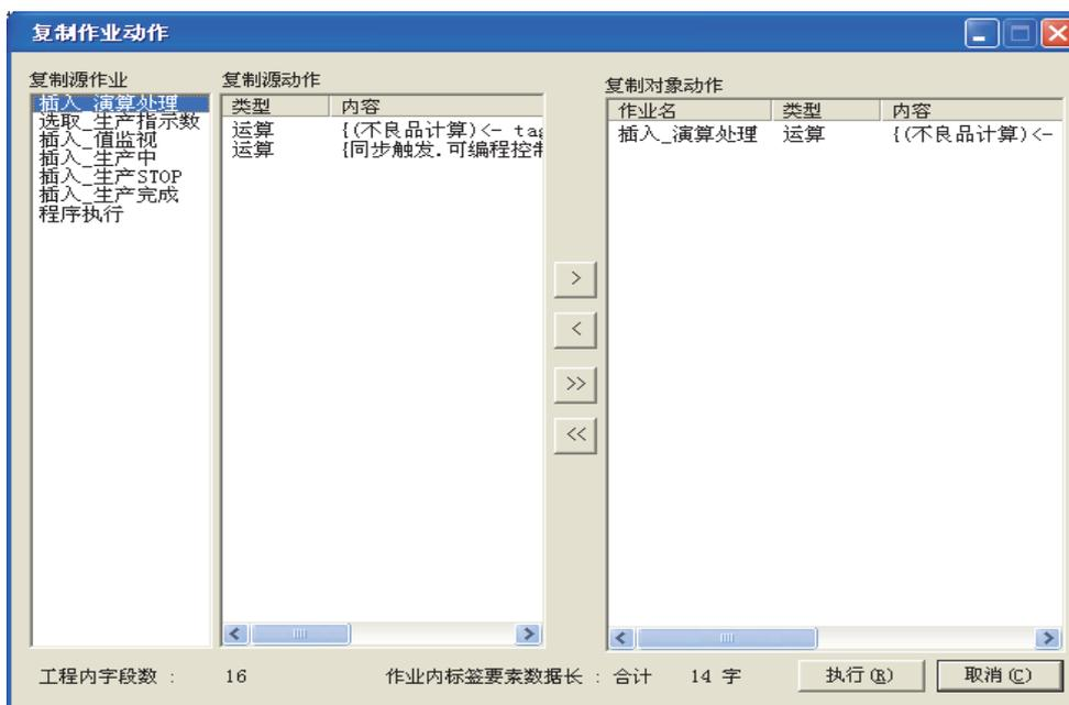
**Step 3.** 重复以下步骤4~步骤6的操作，选择“复制对象动作”（要复制的动作）。
