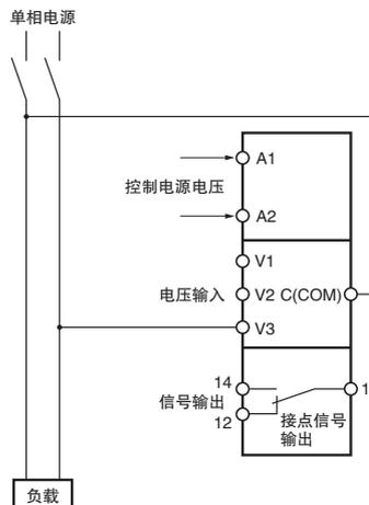
注: DC电压输入时, 没有极性区分。
