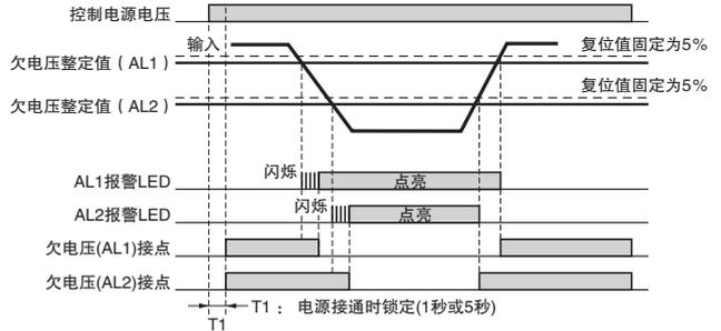
注1. K8AK-VW□的输出接点为正常时动作状态。
