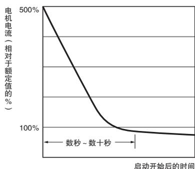
额定电流5A的电机，启动电流会达到30A左右。
