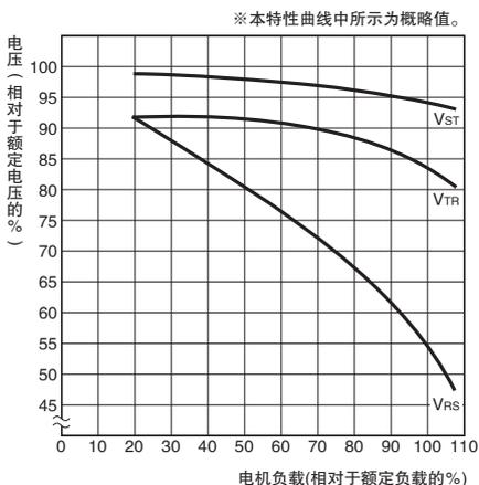
注. 图中所示为R相缺相时的情况。V<sub>st</sub>、V<sub>tr</sub>、V<sub>rs</sub>为缺相时电机端子上的电压。
