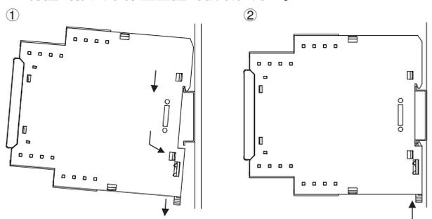
· 拆卸时，用一字型螺丝刀等把挂钩向下拉出，从下侧拉起。
