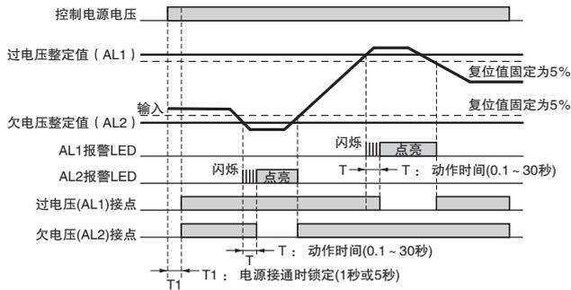
注1. K8AK-VW□的输出接点为正常时动作状态。
