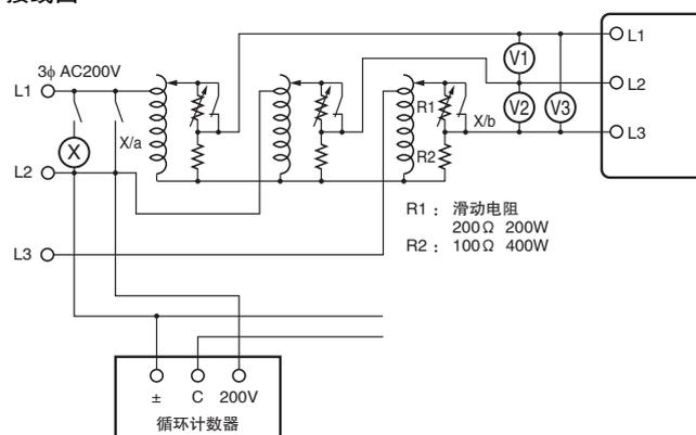
**Q** 三相电压中只有1相超过过电压整定值时，会检测过电压吗？
