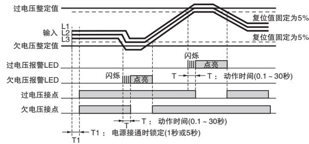
注1. K8AK-PW□的输出接点为正常时动作状态。
