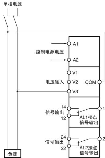
注. DC电压输入时, 没有极性区分。
