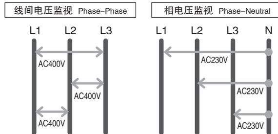
1台即可完成三相电压的全世界规格电源监视
