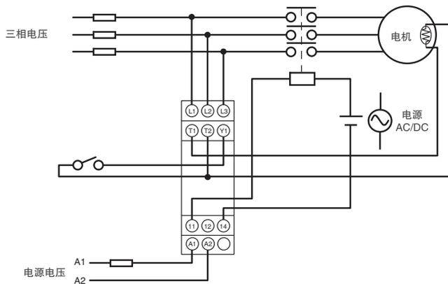
注. DC电压输入时,没有极性区分。
