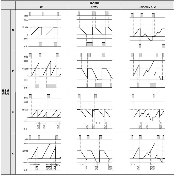
**注1.** t: 输出时间、t-a<t: 表示输出时间以内。 **2.** 如果输出为ON时电源断电,当电源恢复供电时输出ON。输出为一次性输出时,电源恢复后,将再次输出已设定好的部分。 **3.** 在一次性输出中,即使发生再次输出时机也被忽略。
