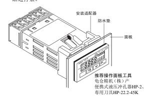
•操作部位为防水结构 (依据NEMA4X、IP66), 另附有防水垫, 因此水也不会从定时器本体与操作面板的间隙渗入。为确保 NEMA4的防水性能,请使用防水垫。如果该防水包装没有充分 压好, 面板内部可能会进水, 因此请务必在紧固安装适配器 (Y92F-30)的安装加强螺钉后使用。
