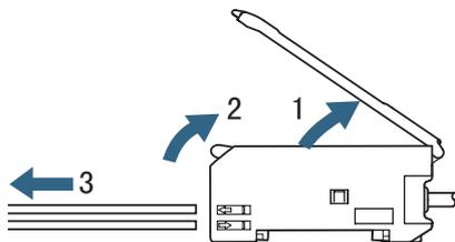
注. 为保持光纤的特性, 请确认锁定状态是否解除后再拔出光纤。
