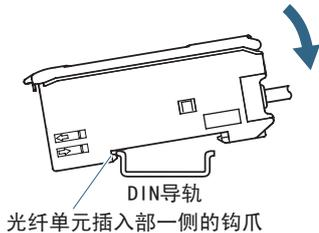
注. 请务必将光纤单元插入部一侧嵌入导轨进行安装。
