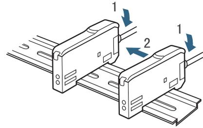
注. 因为会有振动等可能导致连接部脱离时，请使用另售安装配件(PFP-M)进行固定。
