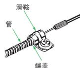
光纤接插件(E39-F10)的安装方法
